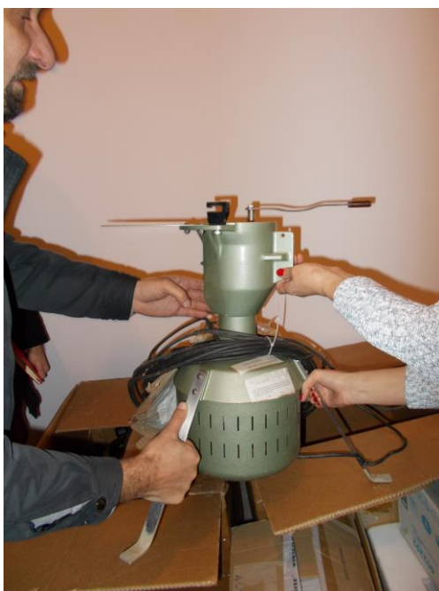
Rysunek 2: Aparat Burkarda "sporetrap" przed założeniem statecznika
