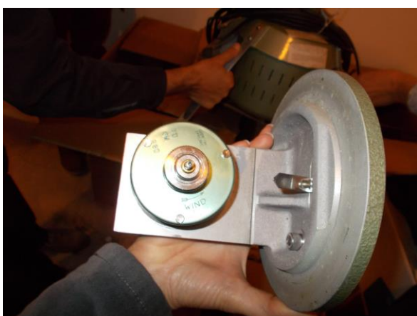
Rysunek 3 Bęben na taśmę klejącą do gromadzenia zarodników z powietrza
